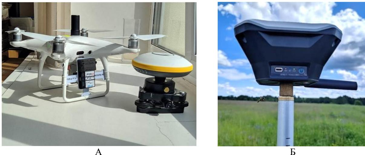
Рис. 2. БПЛА DJI Phantom 4 Pro v2: А – ГНСС-приемник E-Survey; Б – ГНСС-приемник Emlid RS+
