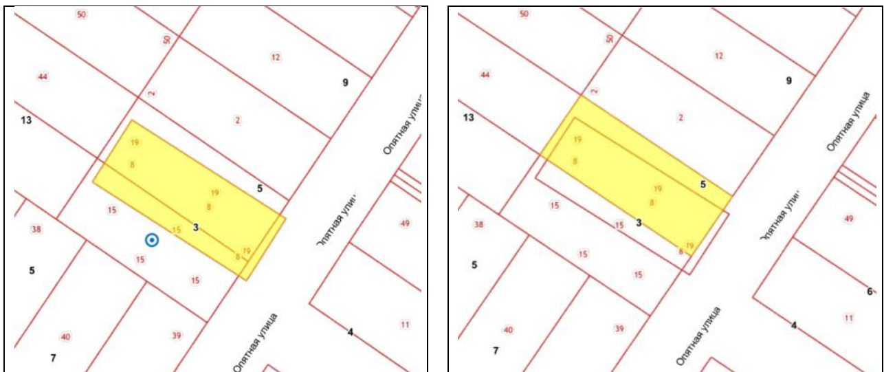
Рис. 3. Примеры реестровых ошибок, связанных с наложением земельных участков Fig. 3. Examples of registry errors related to overlapping land parcels
