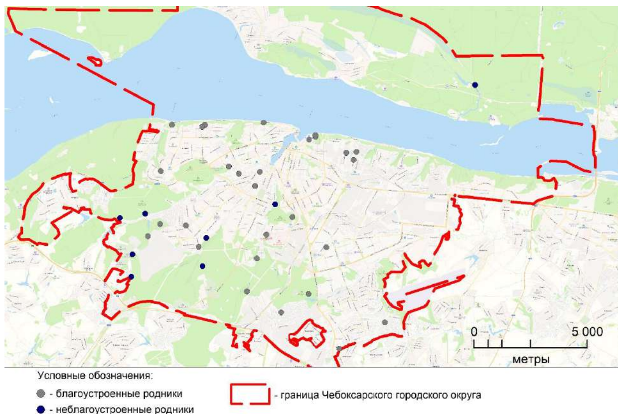
Рис. 2. Карта распространения суффозионных процессов в пределах Чебоксарского городского округа
