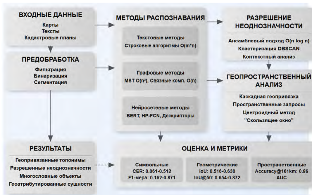
Рис. 4. Комплексная архитектура автоматического распознавания топонимов: от данных к результатам Fig. 4. Comprehensive architecture of automatic toponym recognition: from data to results
