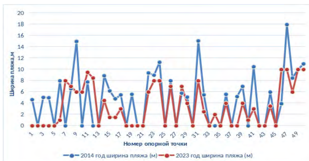
Рис. 8. Сравнение ширины пляжной зоны массива Туапхат в 2014 и 2023 гг. по опорным точкам Fig. 8. Comparison of the width of the beach area of the Tuaphat massif in 2014 and 2023 by reference points
