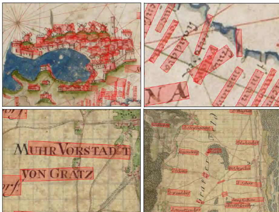
Рис. 3. Типичные ошибочные ситуации, встреченные в ходе экспериментов: помехи из-за символов и декоративных элементов (верхний левый); помехи из-за линейных элементов, сливающихся с топонимами, и «перекрестные помехи» между топонимами (верхний правый); разделенные топонимы (нижний левый), необнаруженный крупноформатный топоним (нижний правый) [Simon et al., 2014]
