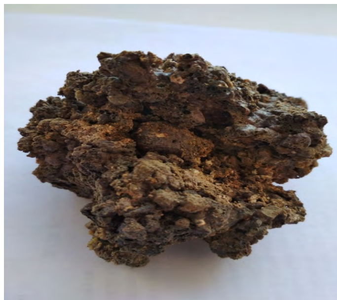
Рис. 2. Шлак после автономного замкнутого деструктора низкого давления Fig. 2. Sludge after an autonomous closed low pressure destructor
