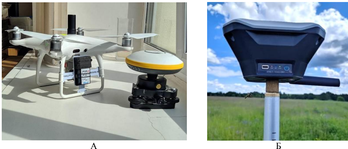
Рис. 2. БПЛА DJI Phantom 4 Pro v2: А – ГНСС-приемник E-Survey; Б – ГНСС-приемник Emlid RS+ Fig. 2. DJI Phantom 4 Pro v2: А – E-Survey GNSS receiver; Б – and Emlid RS+ GNSS receiver
