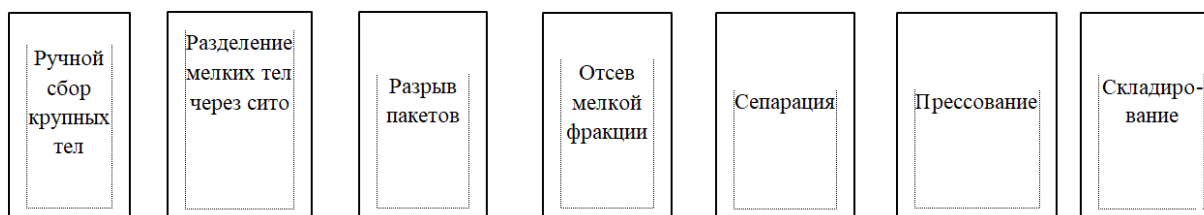
Рис. 2. Этапы процессов сортировки отходов
