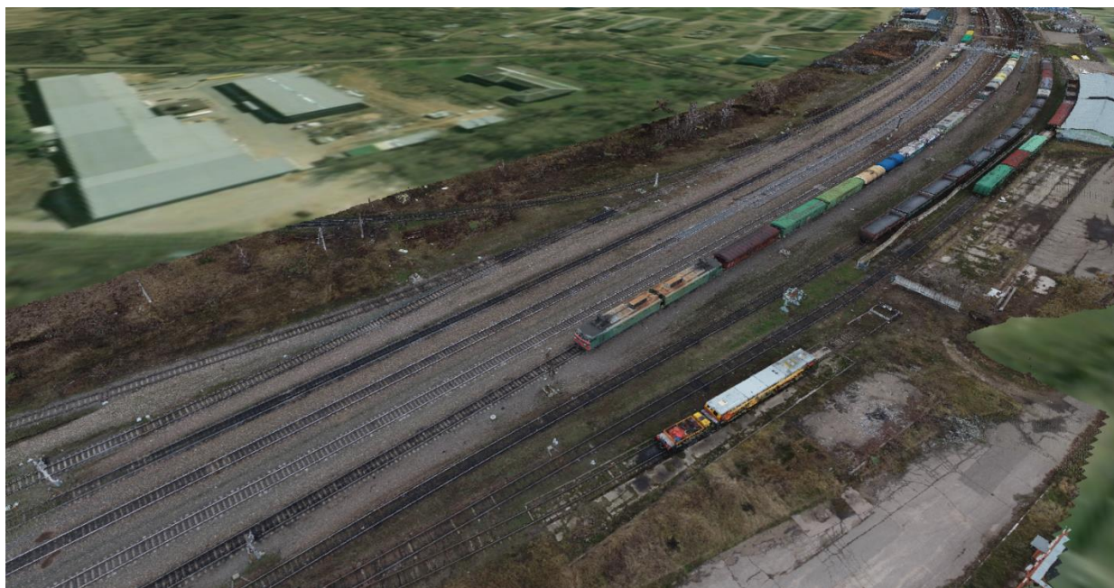
Рис. 1. Трехмерная цифровая модель, построенная по данным ВЛС и космического снимка Fig. 1. Three-dimensional digital model built according to ALS data and a satellite image
