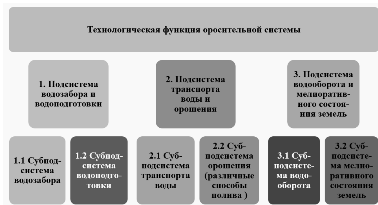
Рис. 1. Взаимосвязанность подсистем, выполняющих технологические функции оросительной системы Fig. 1. The interconnection of subsystems that perform the technological functions of the irrigation system
